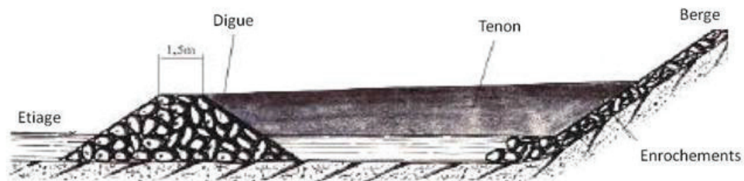
Coupe d'une digue et d'un tenon (enrochements) Source : thèse de P. Valette
