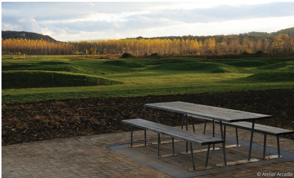
Les stations sont composées d'un platelage de pavés de bois, sur lequel est disposé du mobilier créé à partir de matériels courants (fer à béton, bois traité).
