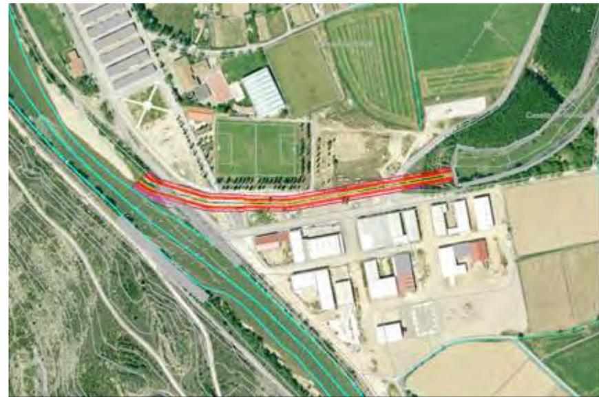
Trazado en planta del cauce de conexión de entrada del cauce activo con el meandro del Soto Sardillas Fuente: CHE
